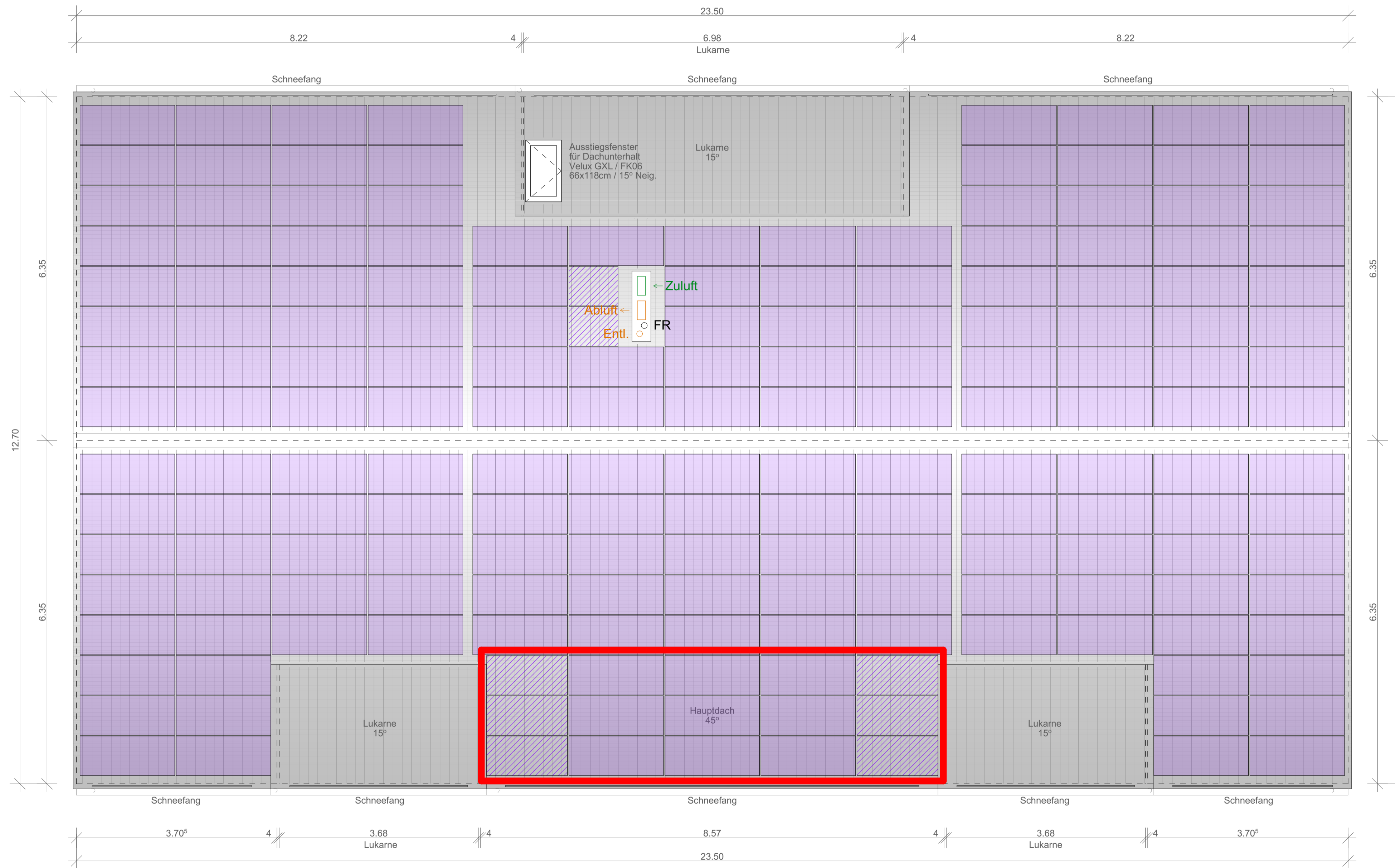
Horizontalprojektion Dachfläche mit Aufdach-PV-Anlage (Hauptdachneigung = 45°)
